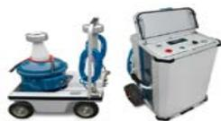
Аппарат испытательный HVTS-HP - универсальная серия приборов (с возможностью укомплектования высоковольтными блоками 10 - 350 кВ до 70 кВА), предназначенных для испытания изоляции силовых кабелей и твердых диэлектриков напряжением постоянного тока величиной до 140 кВ, а также для испытания твердых диэлектриков синусоидальным электрическим напряжением величиной до 100 кВ частотой 50 Гц.
