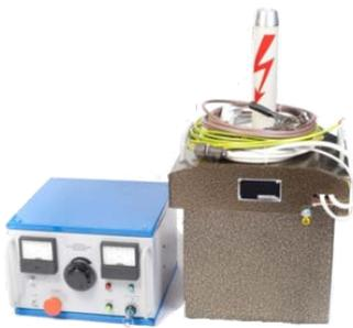
Аппарат испытательный HVA-70 (в дальнейшем – аппарат) предназначен для испытания изоляции силовых кабелей и твердых диэлектриков выпрямленным электрическим напряжением, а также для испытания твердых диэлектриков синусоидальным электрическим напряжением частотой 50 Гц. Аппарат выполнен в виде двух переносных блоков, соединенных кабелем: блока высокого напряжения (БВН) и блока управления (БУ). Отличительной особенностью является наличие цифровой индикации результатов измерений.
