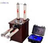
Аппарат высоковольтный АВ-25-0,1 предназначен для испытаний кабеля из СПЭ рабочим напряжением до 25кВ и длиной до 5 км.
