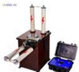
Аппарат высоковольтный испытательный. Предназначен для испытания кабелей с изоляцией из сшитого полиэтилена.
