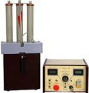
AB-50/70 Применяется для проверки и аттестации высоковольтных кабелей, качества диэлектрических изоляторов на распределительных пунктах электрических сетей и трансформаторных подстанциях, в составе передвижных электротехнических лабораторий. Возможно применение в стационарных электрофизических лабораторий в качестве источника высокого напряжения для проверки твердых диэлектриков.
