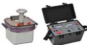
Аппарат испытательный диодный АИД-70/50 предназначен для испытаний напряжением постоянного тока (до 70 кВ) изоляции силовых кабелей (IEC 60502-2), арматуры силовых кабелей (IEC 61442), а также для испытаний напряжением переменного тока (до 50 кВ) распределительных устройств, автоматов повторного включения, диэлектрических изоляторов, ограничителей перенапряжения (разрядников), сборных шин и иных твердых диэлектрических материалов с относительно небольшой электрической емкостью.
