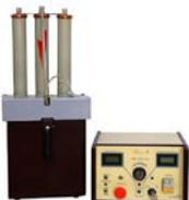
Аппарат испытательный высоковольтный AB-50/70PP с блоком управления на дискретных элементах
