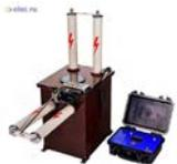
Аппарат испытательный "АВ-45-01 (АВ-60-01)" предназначен в качестве приставки к высоковольтным испытательным установкам для получения испытательного напряжения на емкостных объектах частоты 0,1 Гц, в т. ч. для испытания кабелей из сшитого полиэтилена.
